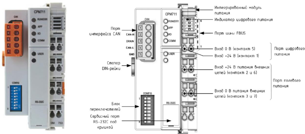
Предназначен для управления модулями ввода-вывода Fastwel I/O в системах сбора и обработки данных, построенных на базе интерфейса CAN и протоколов прикладного уровня CANopen.
