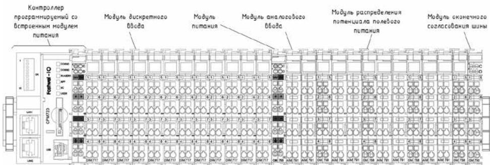
Конфигурация ПЛК может включать в себя несколько смежных наборов периферийных модулей, размещаемых в пределах одного шкафа или другой оболочки и соединенных стандартными кабелями TIA/EIA-568-В (патч-корд).
