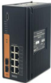
Для организации взаимодействия ПЛК Fastwel по сети Ethernet между собой, а также с другими устройствами в рамках единой АСУ ТП рекомендуется использовать управляемые коммутаторы Fastwel NM800, обеспечивающие построение надежных, отказоустойчивых и мультисервисных сетей передачи данных, функционирующих в неблагоприятных условиях окружающей среды.
