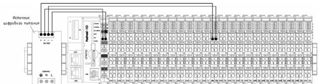
Питание внешних цепей, связанных с датчиками и исполнительными устройствами и подключаемых к модулям ввода-вывода Fastwel I/O, осуществляется напряжением 24 В постоянного тока, которое подается на контакты ввода напряжения полевого питания модулей питания в составе контроллеров, модулей NIM745, OM753, OM757, OM751 или OM752. При этом суммарное значение тока, потребляемого нагрузками периферийных модулей от шины полевого
