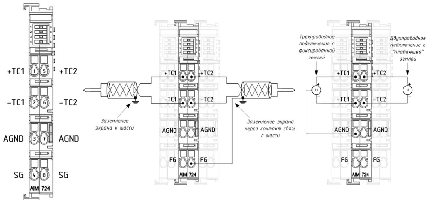
Имеет два дифференциальных канала аналогового ввода и предназначен для измерения температуры при помощи термопар или напряжения постоянного тока малой величины.
